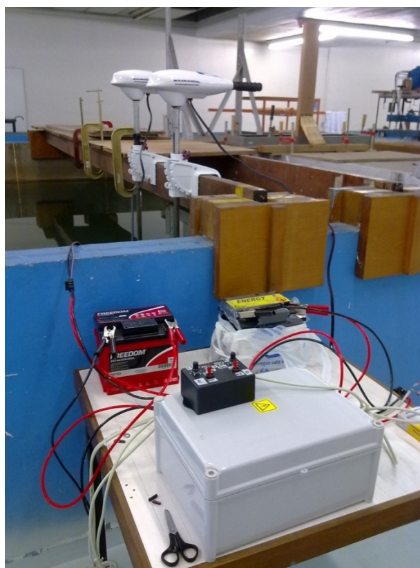
Figura 6-23 Circuito completo, com baterias e propulsores ao fundo
