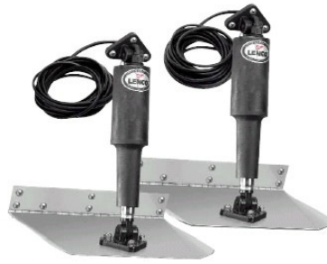
Figura 2-5 Kit de hidrofólios e atuadores lineares. Fonte: it.cosasdebarcos.com
